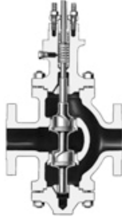
图3-7. 反作用双阀座直通式阀体
