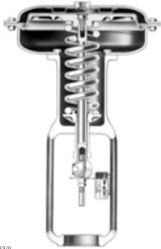
图8-4. 典型的弹簧薄膜执行机构
