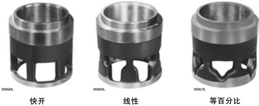
图3-28. 直通式阀体的特性化阀笼
