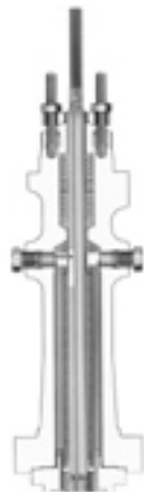
图3-18. 波纹管密封型阀盖
