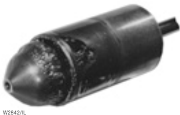
图 5-6. 闪蒸破坏的典型外形
