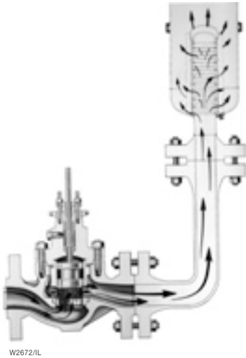
图5-10. 阀门和排空扩散器组合
