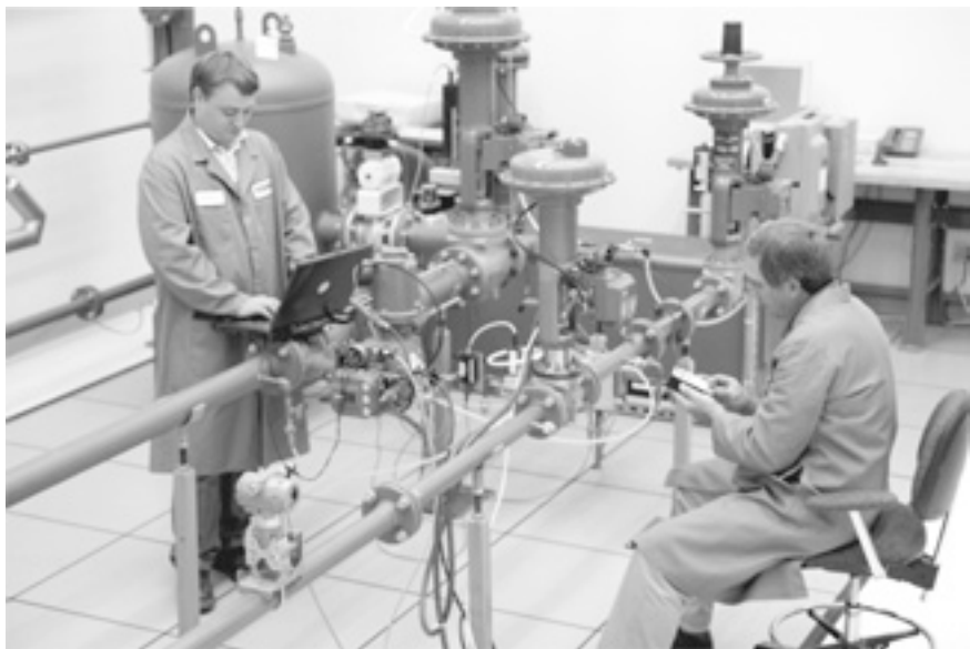
图2-2. 性能测试回路
