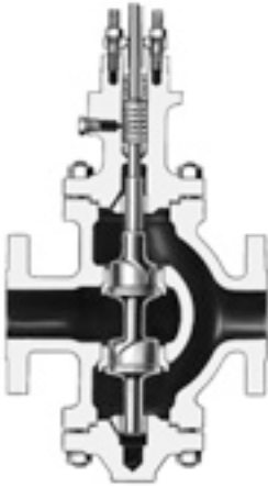
图 1-9. 反作用双阀座直通阀阀体
