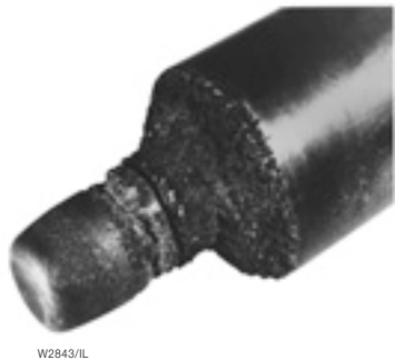
图 5-7. 气蚀破坏的典型外形
