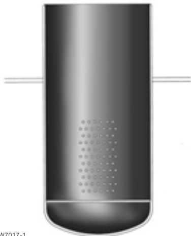
图7-12. 带钻孔噪音控制技术的蒸汽喷淋器
