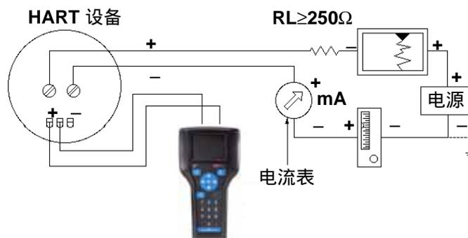
图 3-5 显示如何连接可选的 250 欧姆电阻。如果 HART 回路中电阻小于 250 欧姆，则需要附加电阻。
