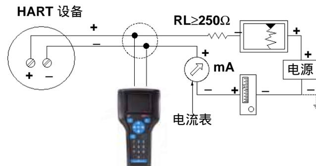
图 3-4 显示如何将 475 现场通讯器直接连接到 HART 设备端口。
