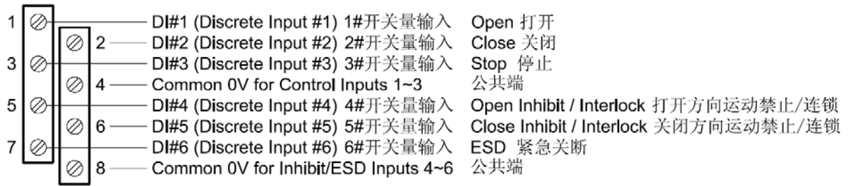
图 3-7-1 远程控制接线 Figure 3 – 7 - 1 Control Input Wiring
