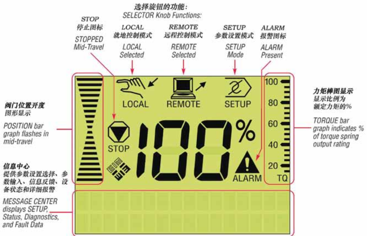
图4: LCD 液晶屏幕显示 (提供清晰易懂的图形和文字信息显示)
