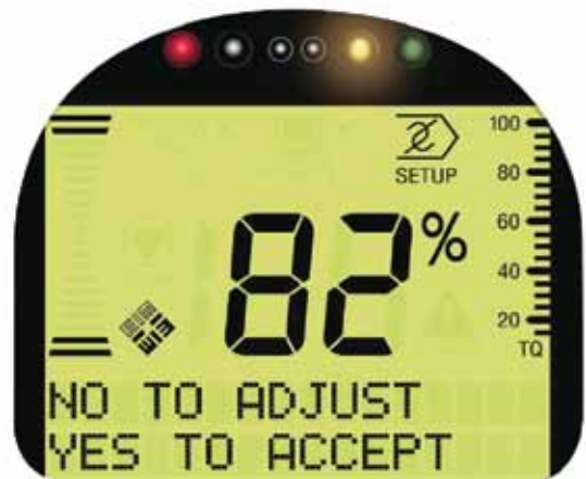
TEC2000 电动执行机构的图标和文字综合显示 电动执行机构处于SETUP参数设置模式, 阀门开度为82%
