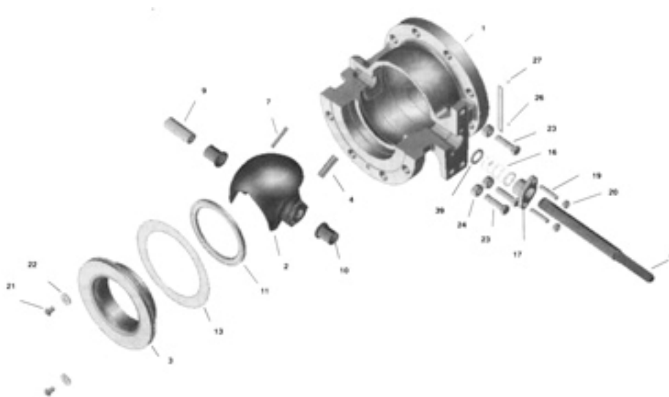
图 24. V150 和 V300 型，尺寸为 3 至 12 英寸，不带消音器的阀门组件分解图
