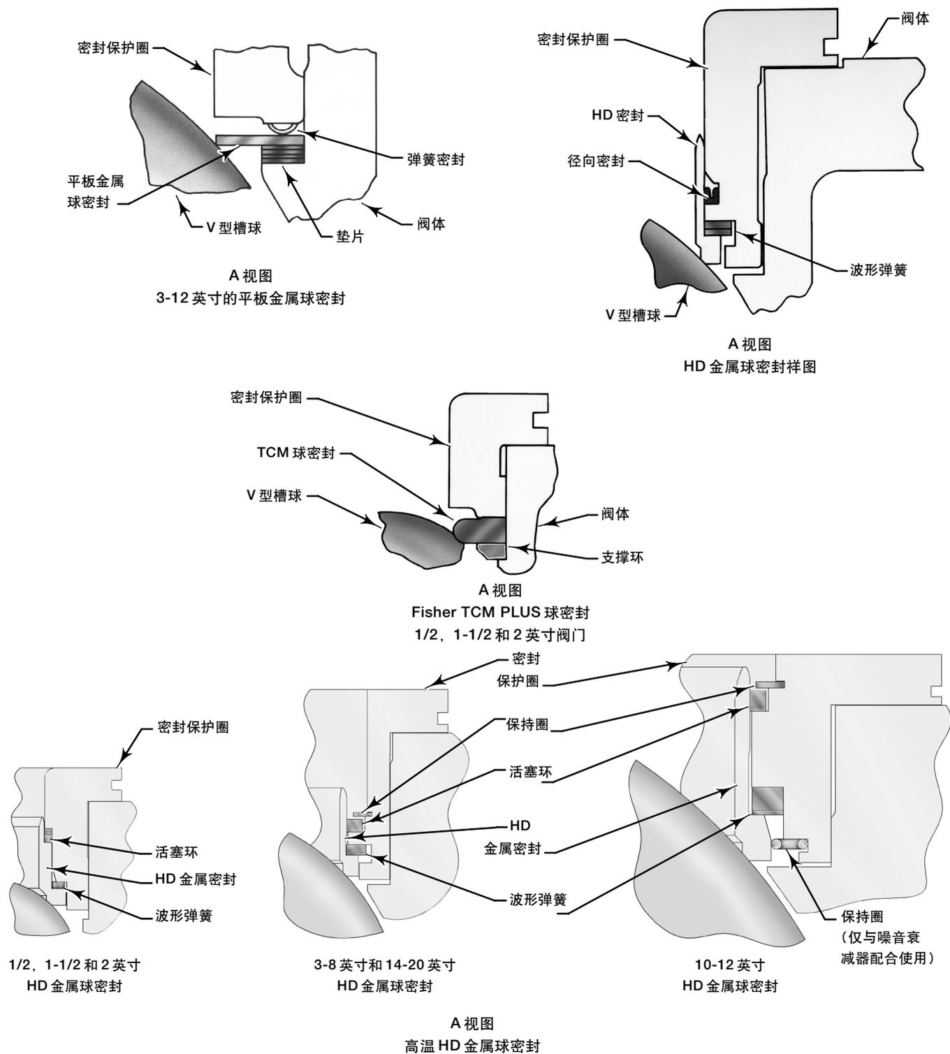
图2. Vee-Ball® 结构特征和密封 (图示为V150型)
