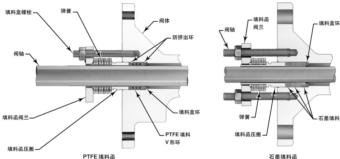
图5. 典型ENVIRO-SEAL (环保密封) 填料函配置
